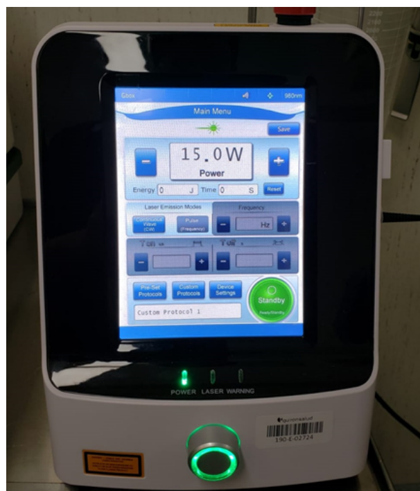
Figura 2: Configuración del láser de diodo de 980 nm. En potencia de 15 Watts.
